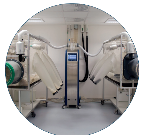
ScanClime liefert befeuchtete/entfeuchtete Luft an Isolatoren
