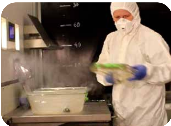
Downflow und Inflow stellen sicher, dass keine Krankheitserreger oder Allergene in die Umgebung der Kabine entweichen können (das obige Bild wurde bei einem Rauchtest aufgenommen).
